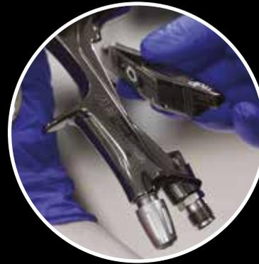
Klammer verwenden, einrasten lassen und Lackierpistole reinigen
